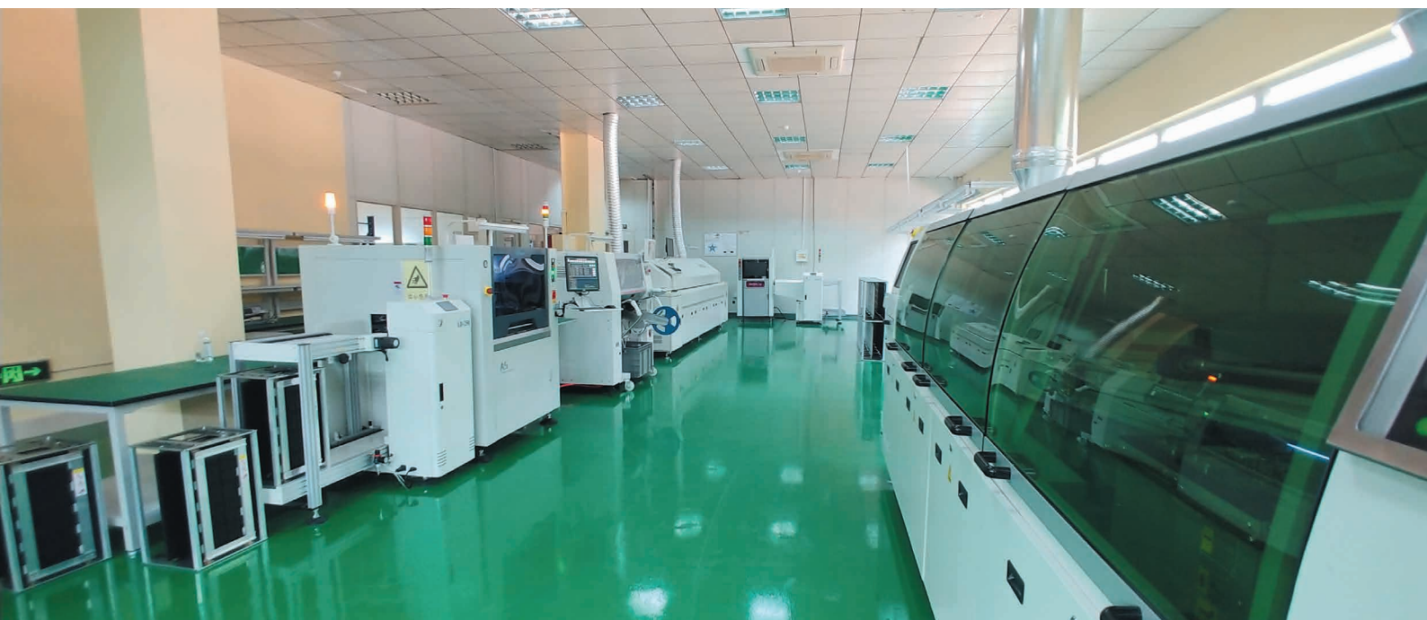
КИТАЙ, СУЧЖОУ. Автоматическая линия по SMT и DIP монтажу компонентов
