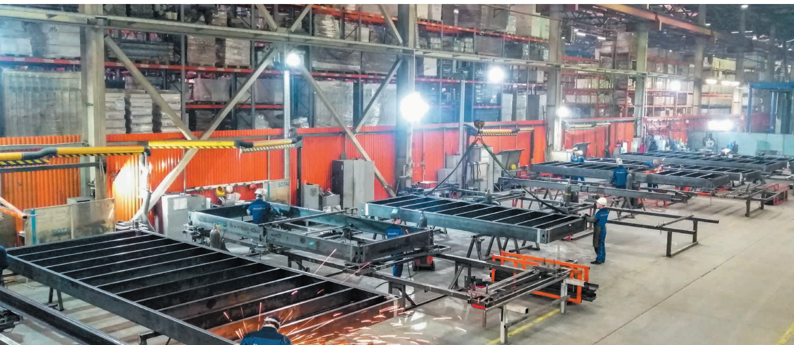
РОССИЯ, НОВОСИБИРСК. Участок сварки рам модульных конструкций
