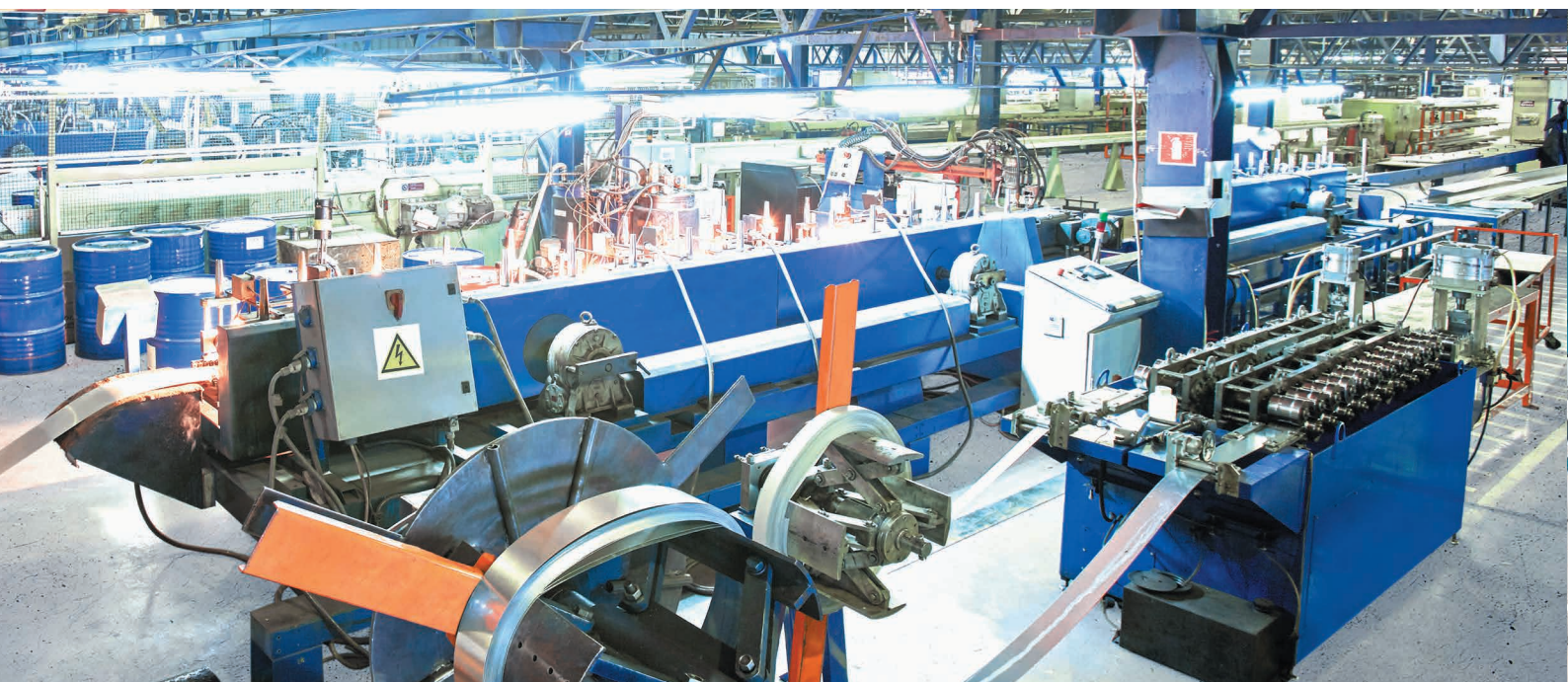
РОССИЯ, МОСКВА. Автоматические линии по производству роллетных профилей
