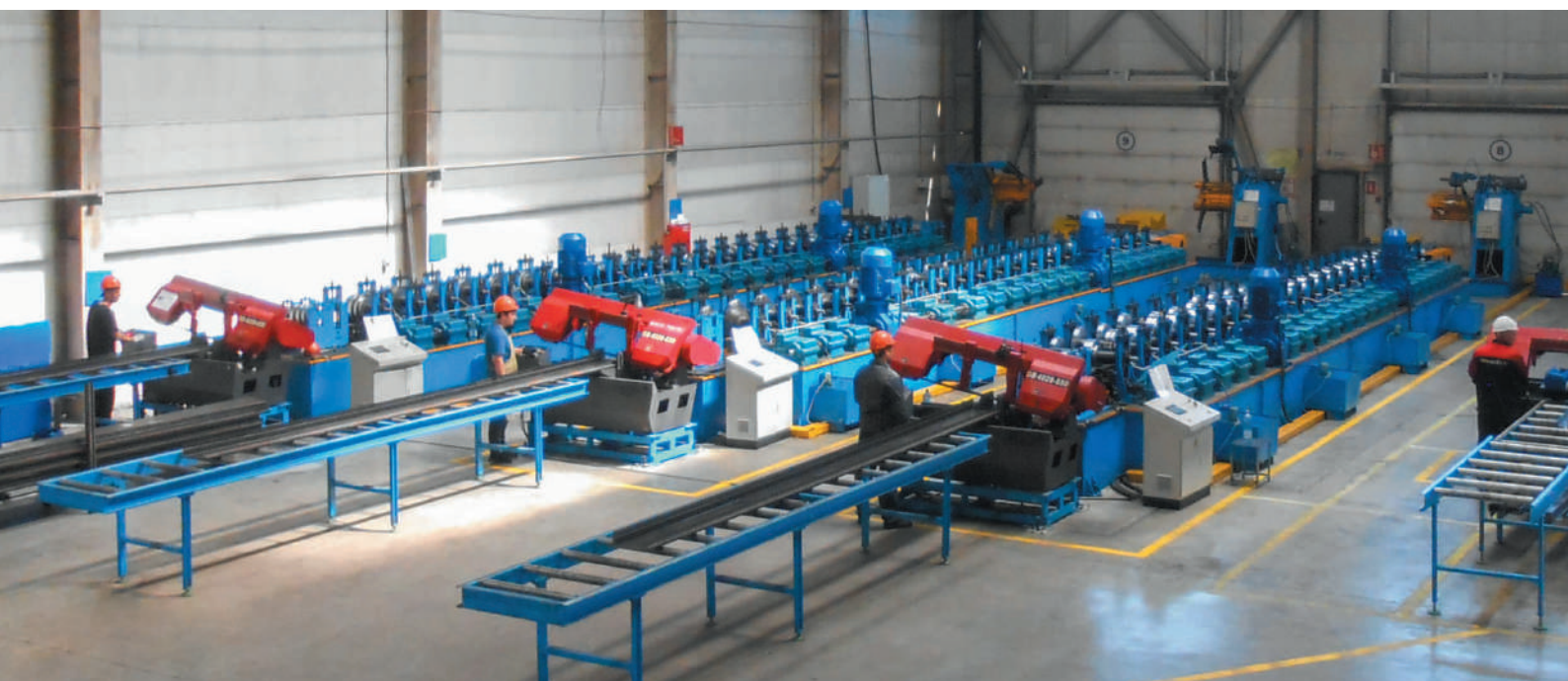
РОССИЯ, НОВОСИБИРСК. Участок профилирования рам модульных конструкций
