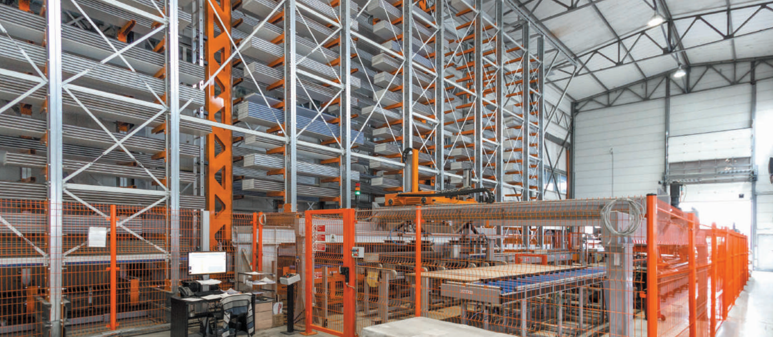
РОССИЯ, МОСКВА. Линия по производству полотна секционных ворот
