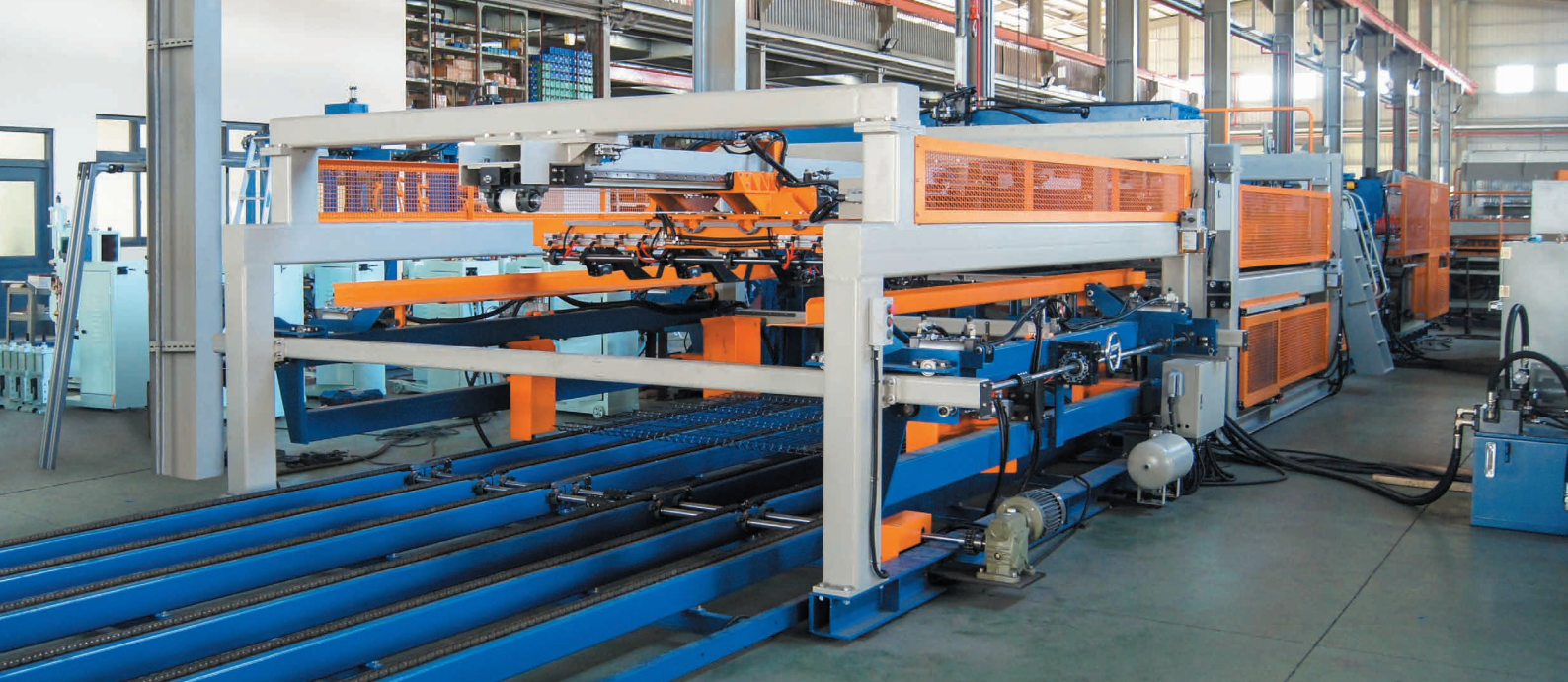
РОССИЯ, НОВОСИБИРСК. Линии сварки и профилирования заборных сварных сеток
