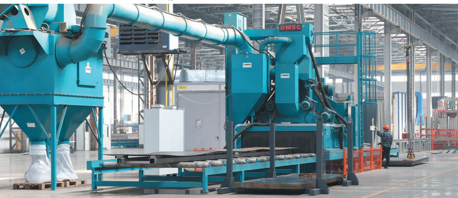
РОССИЯ, МОЖАЙСК. Линия по дробеструйной обработке металла
